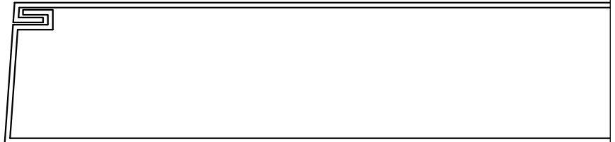
Hemmed Bevel Edge no side channel
